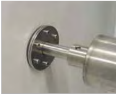
Aandrijfas in koppelbus van buis schuiven.
