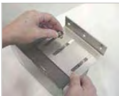
Monteer motorbeugel op motor.
