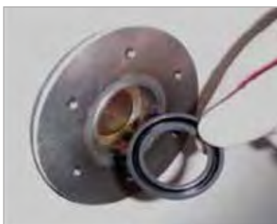
Plaats waterkering met open zijde naar het bad.
