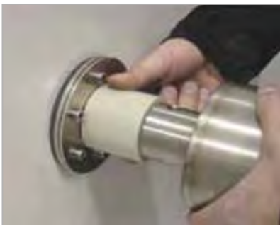
Aandrijfas terughalen en afstandsbus tussen plaatsen en fixeren met M10 bout.
