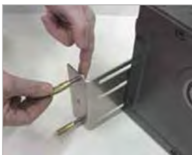
Tapbout + plug aan motorbeugel draaien en vet in de motorbuis aanbrengen.
