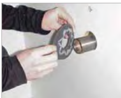
Pakking met kit plaatsen in motorput.
