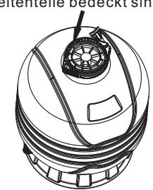
3/ Gießen Sie die empfohlene Menge Sand in den Tank. Stellen Sie sicher, dass das Mittelrohr dabei zentriert und senkrecht bleibt.
